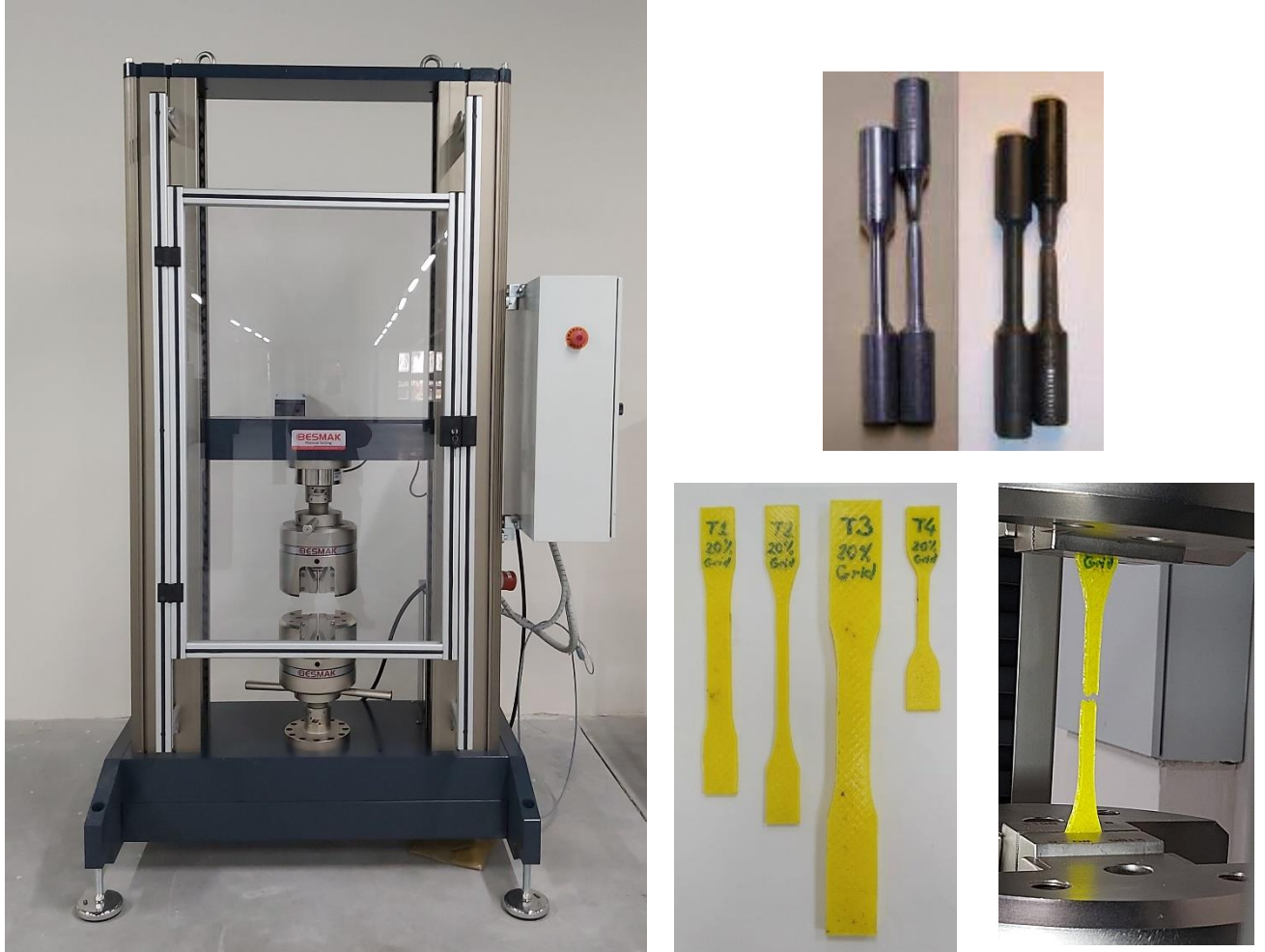
Şekil 1. Çekme deney makinası ve Çekme deneyinde kullanılan numuneler
